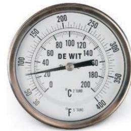
Funcionan según el principio de medición por dilatación de gas, por la expansión diferente de un bimetalo o por expansión de un líquido y pueden medir temperaturas con rangos entre  $-200 \dots +700 \text{ }^\circ\text{C}$ .
